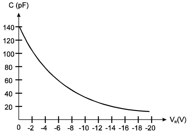
Şekil 2.21 . Bir varaktör diyotta kapasitenin gerilime bağlı değişimi.
