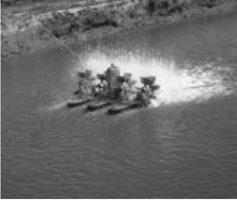
Şekil 3: Toprak havuzda aeratör
