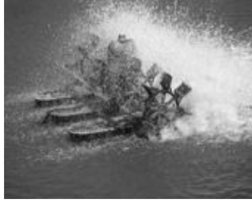
Şekil 4: Toprak havuzda aeratör
